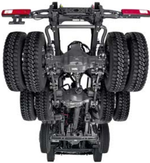
PONT TANDEM À DOUBLE RÉDUCTION pour plus de motricité sur les terrains difficiles.
