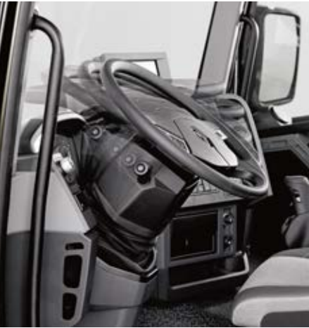
VOLANT RÉGLABLE EN TROIS DIMENSIONS hauteur, profondeur, inclinaison.
