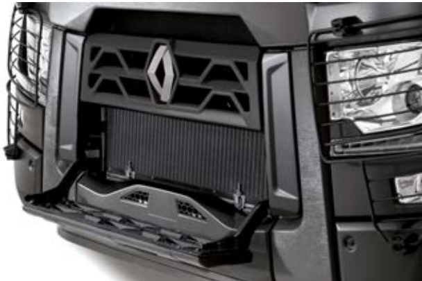
MARCHES D'ACCÈS PARE-BRISE anti-dérapantes pour faciliter l'entretien du véhicule.
