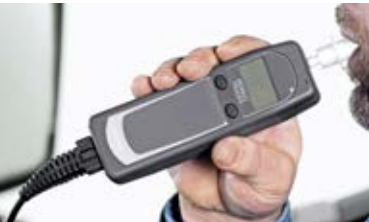
ETHYLOTEST ANTI-DÉMARRAGE permet un contrôle de l’alcoolémie du conducteur avant le démarrage du véhicule.
