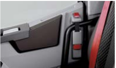
VERROUILLAGE MÉCANIQUE DES PORTES permet une fermeture supplémentaire des portes de l’intérieur du véhicule.
