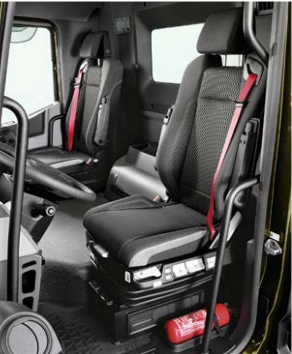
SIÈGES SUSPENDUS VENTILÉS chauffants avec ceintures embarquées, appuie-tête, réglages de soutien latéral et lombaire, plage de recul de 20 cm pour plus d’espace aux jambes.
