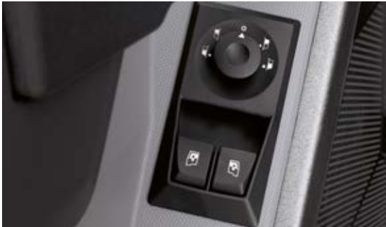
GESTION DES VITRES ET RÉTROVISEURS LATÉRAUX lève-vitres impulsif et réglages des rétroviseurs principaux et grand angle électriques.
