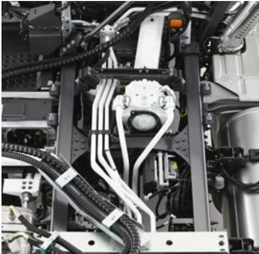
POMPE HYDRAULIQUE entraînée par la prise arrière du moteur.
