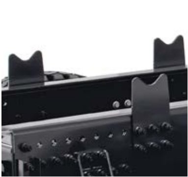
CORBEAUX PLAQUÉS SUR LONGERONS pour faciliter les opérations de carrossage.
