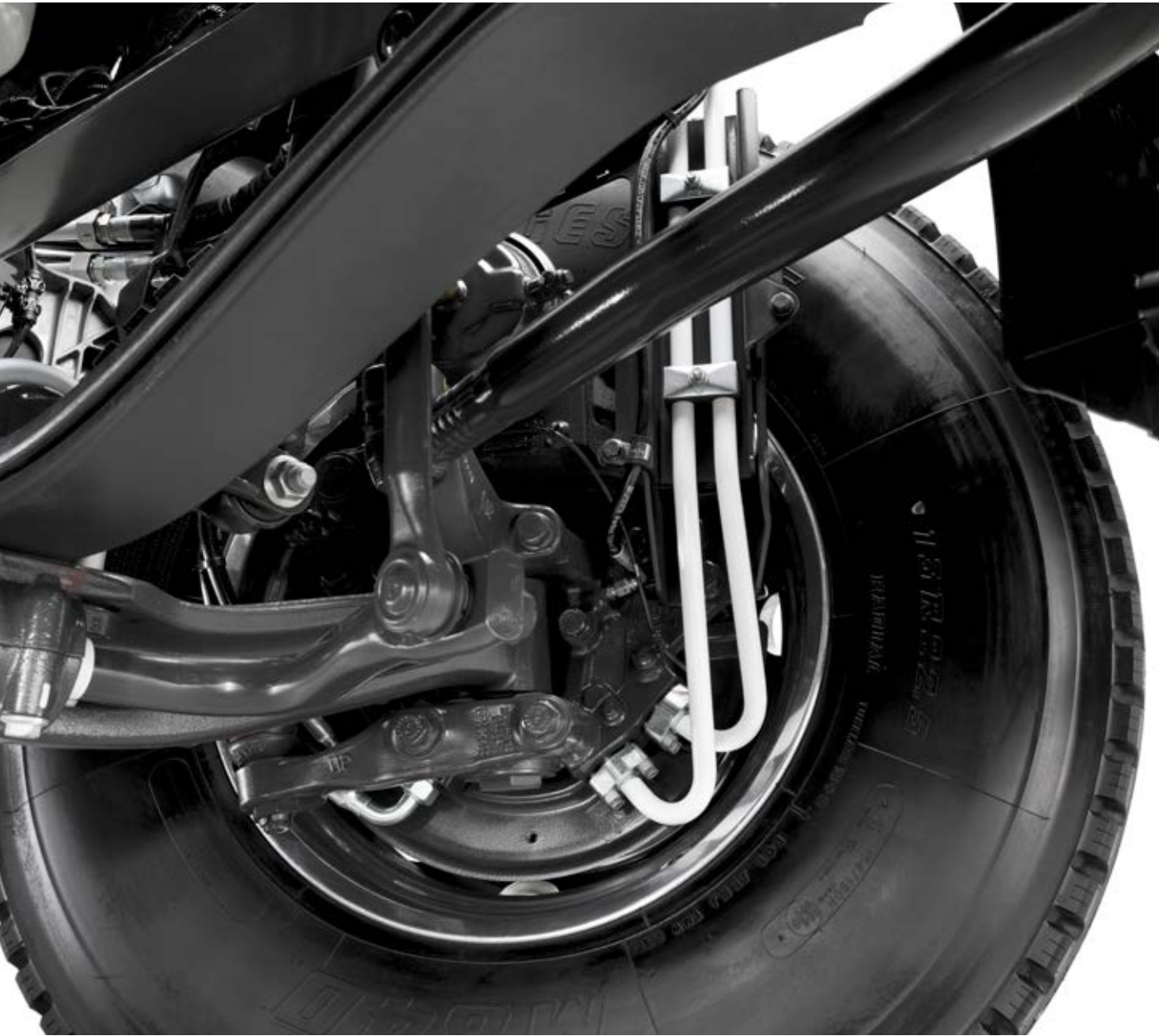
ESSIEU AVANT ÉQUIPÉ DE 2 MOTEURS HYDRAULIQUES d’une puissance unitaire de 41 kW.
