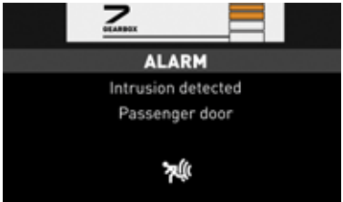
ALARME ANTI-INTRUSION prévient le conducteur en cas d’ouverture des portières.
