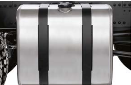
RÉSERVOIR EN ALUMINIUM pour un poids réduit jusqu'à 50 %.
