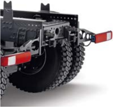
PORTE-À-FAUX ARRIÈRE disponible par tranche de 50 mm pour éviter la recoupe des longerons.
