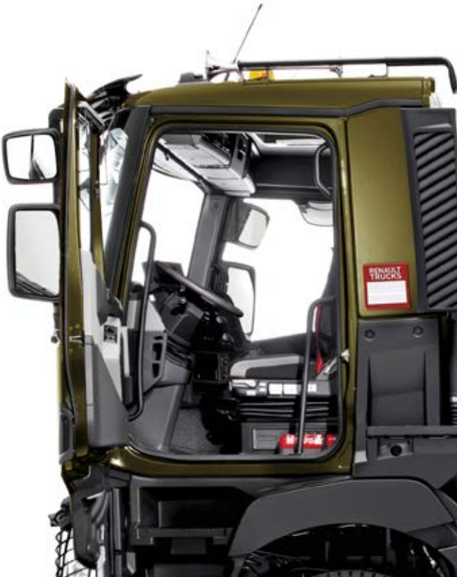
OUVERTURE DES PORTES À 85° pour faciliter l'accès à la cabine.
