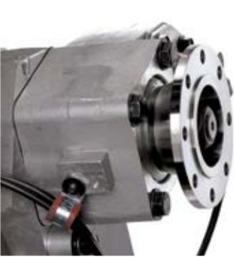
PRISE DE MOUVEMENT pour faire fonctionner les équipements des carrossiers en roulant ou à l'arrêt.
