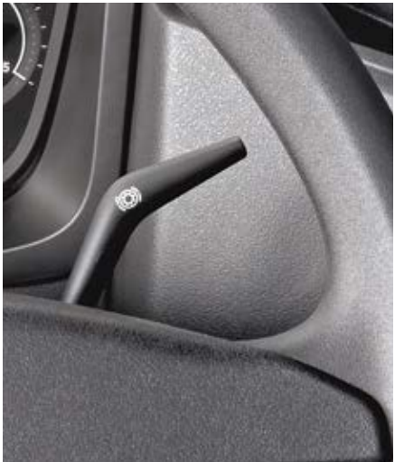
COMMANDE DES RALENTISSEURS moteurs et sur transmission.
