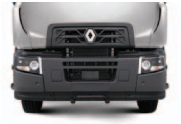
BOUCLIER AVEC COINS ACIER (D WIDE) pour une plus grande robustesse.
