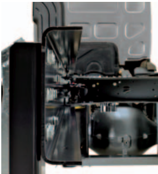
LONGERONS CHÂSSIS acier haute élasticité.
