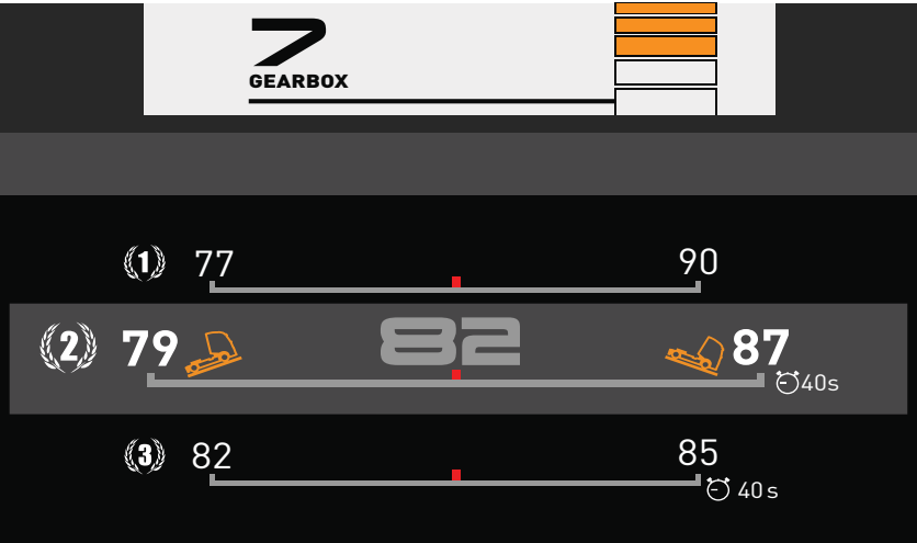
RÉGULATEUR DE VITESSE ÉCONOMIQUE avec trois modes de conduite sélectionnables par le conducteur.
