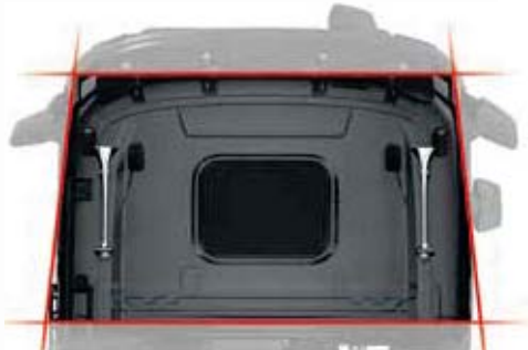
CABINE EN FORME DE TRAPÈZE de 2,3 m à l'avant et de 2,5 m à l'arrière pour favoriser les flux d'air.
