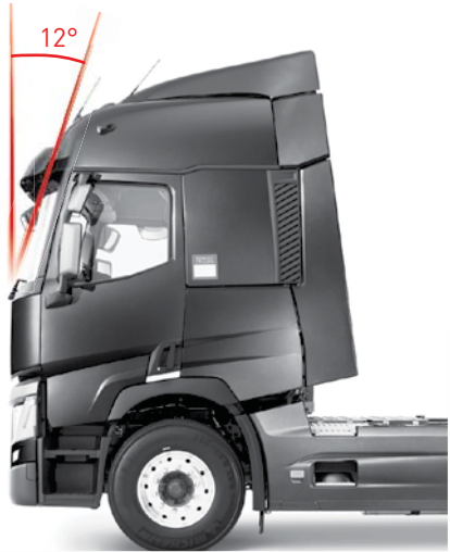
INCLINAISON DU PARE-BRIS DE 12° pour un meilleur aérodynamisme.
