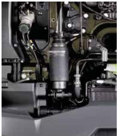
SUSPENSIONS AVANT CABINE PNEUMATIQUES OU MÉCANIQUES adaptées en usage sévère pour une meilleure stabilité du véhicule.
