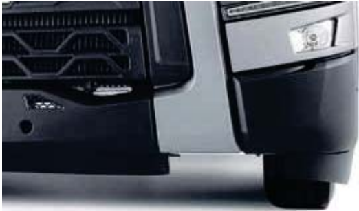
EXTENSIONS AÉRODYNAMIQUES DE BOUCLIER pour une meilleure pénétration dans l'air.
