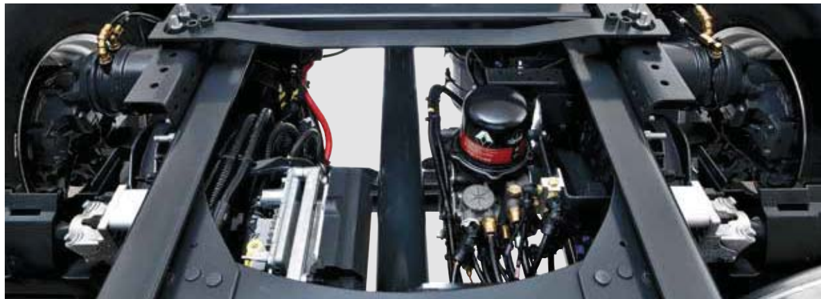
SÉPARATION DES FAISCEAUX ÉLECTRIQUES ET PNEUMATIQUES pour faciliter l'entretien.
