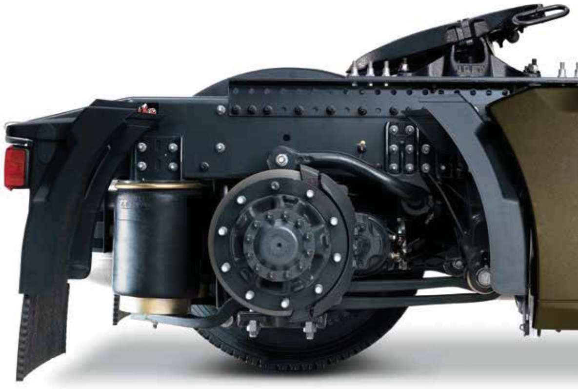
SUSPENSIONS ARRIÈRE CHÂSSIS PNEUMATIQUES d'une capacité technique de 13 t.
