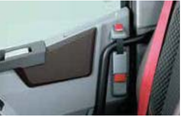
VERROUILLAGE MÉCANIQUE DES PORTES permet une fermeture supplémentaire des portes de l’intérieur du véhicule.
