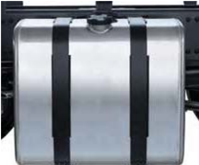
RÉSERVOIR EN ALUMINIUM pour un poids réduit de 50 % par rapport à un réservoir en acier.
