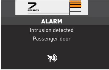
ALARME ANTI-INTRUSION prévient le conducteur en cas d’ouverture des portières.
