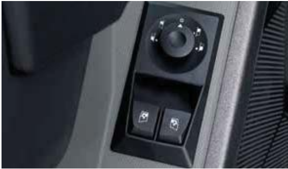
GESTION DES VITRES ET RÉTROVISEURS LATÉAUX avec lève-vitre impulsif et réglage électrique des rétroviseurs principaux et grand angle.
