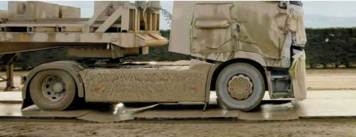
TEST SUR PISTE SÉVÉRISÉE pour valider la solidité et la fiabilité des suspensions.
