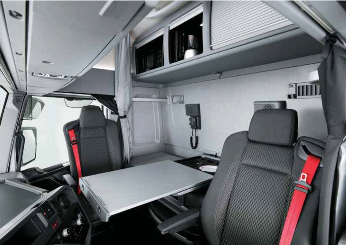
AMÉNAGEMENT CABINE MAXISPACE avec table rétractable et desserte supplémentaire à l'arrière de la cabine composée de 3 coffres de rangement.
