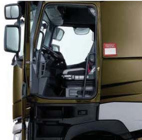
OUVERTURE DES PORTES À 85° et à paliers pour une parfaite accessibilité de la cabine.
