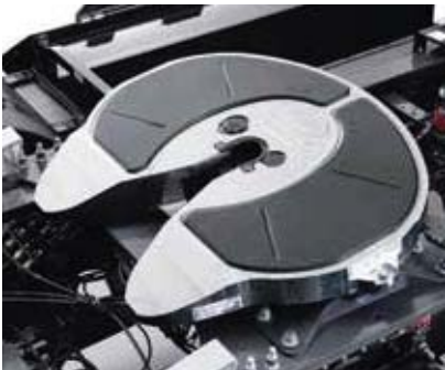
SELLETTE EN ALUMINIUM pour réduire le poids du véhicule de 22 kg.
