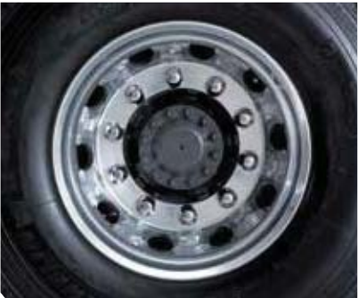
JANTES EN ALUMINIUM pour réduire le poids du véhicule jusqu'à 200 kg.
