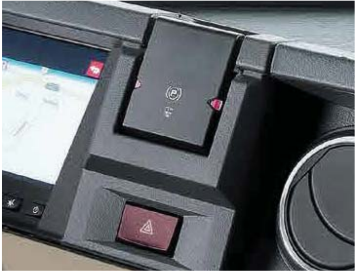
FREIN DE PARC ÉLECTRIQUE AUTOMATIQUE À L'ARRÊT DU MOTEUR
