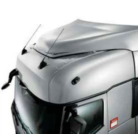
DIFFÉRENTS TYPES DE DÉFLECTEURS DE PAVILLON fixes (88 mm), réglables électriquement ou manuellement (de 285 à 496 mm) et déflecteurs latéraux rabattables.
