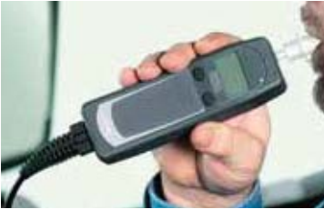
ETHYLOTEST ANTIDÉMARRAGE permet un contrôle de l’alcoolémie du conducteur avant le démarrage du véhicule.
