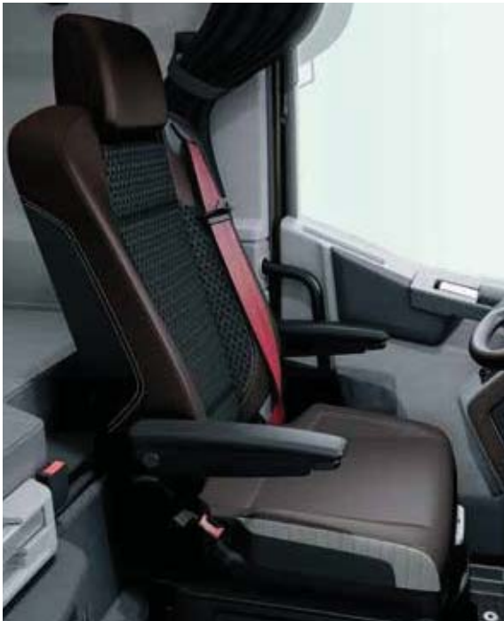
SIÈGES SUSPENDUS AVEC CEINTURE INTÉGRÉE chauffants, ventilés et équipés d'un appui-tête et de maintiens latéral et lombaire réglables. Plage de recul de 20 cm pour plus d'espace aux jambes.
