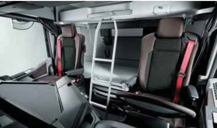
COUCHETTE INFÉRIEURE EXTENSIBLE DE 800 MM DE LARGE mousse haute densité 40 kg/m³ et couchette supérieure accessible par une échelle.
