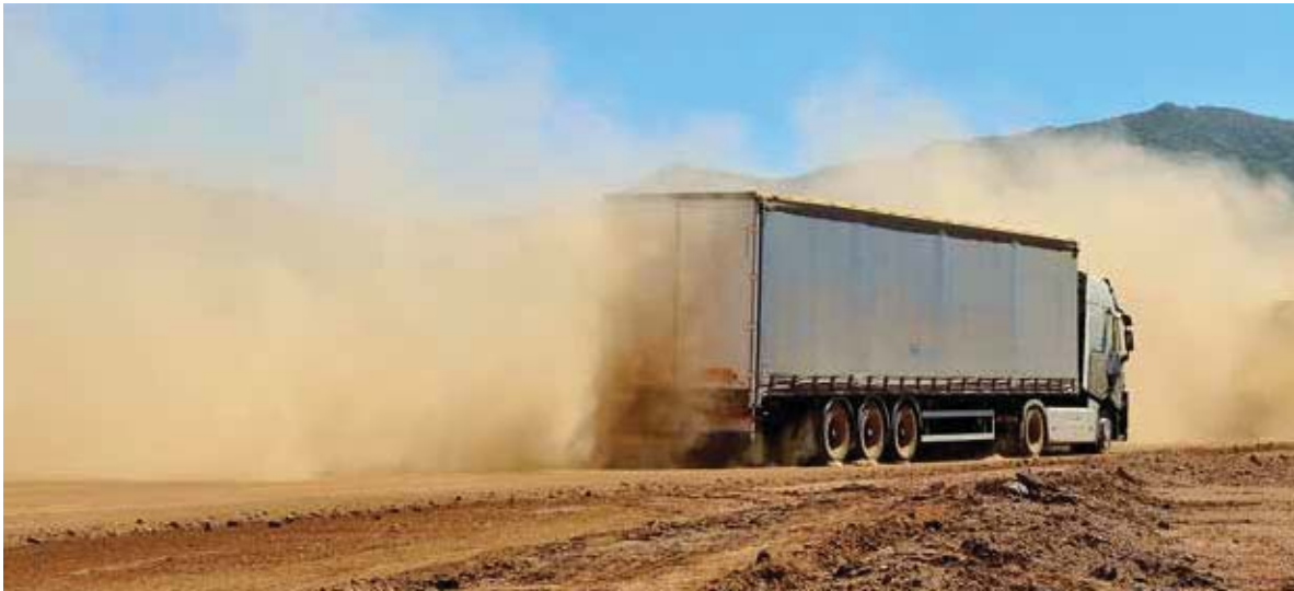
TEST TEMPÉRATURES EXTRÊMES à Almeria (Espagne) pour mesurer la résistance du véhicule en conditions difficiles (poussière, chaleur, etc.).
