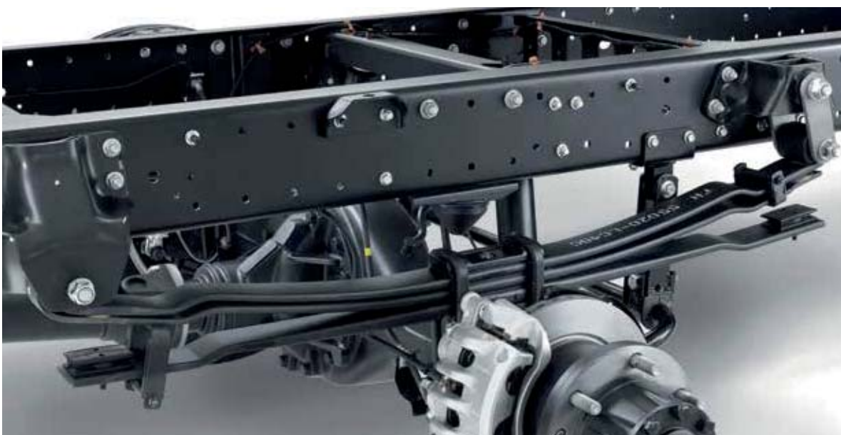
SUSPENSIONS ET PONT DE TYPE POIDS LOURDS Suspensions avant et arrière avec ressorts à lames paraboliques, amortisseurs et barre stabilisatrice.
