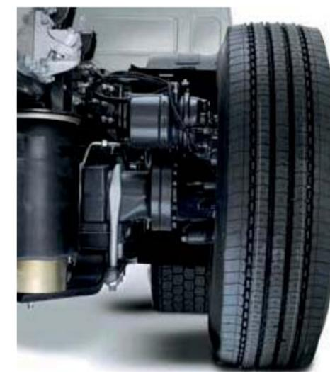
**SUSPENSIONS ARRIÈRE CHÂSSIS PNEUMATIQUES** pour une plus grande stabilité et une meilleure protection des marchandises.
