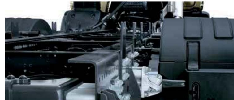
CHÂSSIS PRÉDISPOSÉ POUR CHAQUE MÉTIER avec un kit de boulonnerie, des longerons pré-perçés et des aménagements spécifiques (citerniers, balayeuses, benne à ordures ménagères, pompier).
