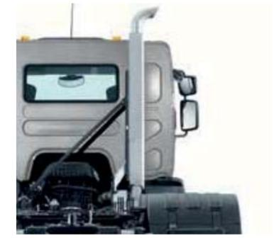
ÉCHAPPEMENT VERTICAL pour carrosser les véhicules tels que benne à ordures ménagères, hydrocureuse ou balayeuse.
