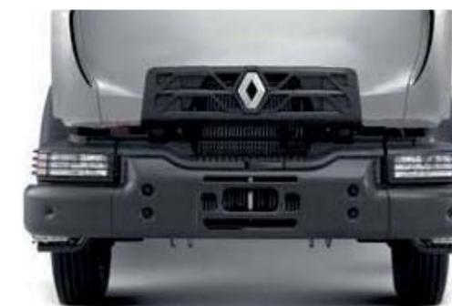
**BOUCLIER 100 % ACIER (D CAB 2.1 M)** pour un usage sévère.
