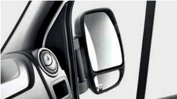
RÉTROVISEURS GRAND ANGLE à réglage électrique avec clignotants intégrés.
