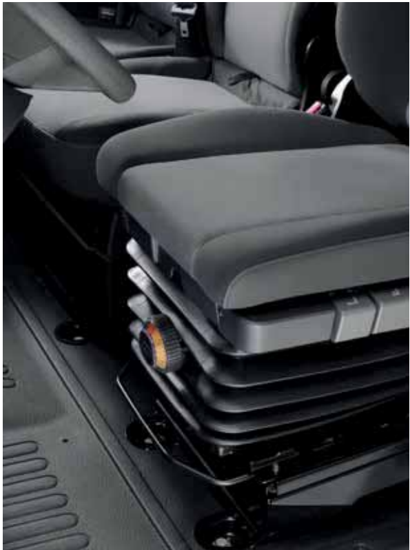
SIÈGE SUSPENDU ajustable en hauteur et en profondeur avec appuie-tête réglable, accoudoir central et soutien des lombaires.
