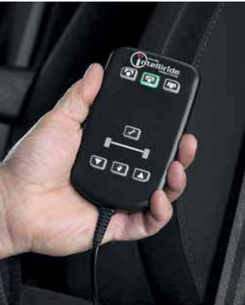
TÉLÉCOMMANDE DE RÉGLAGE DE LA SUSPENSION PNEUMATIQUE pour ajuster la hauteur de chargement et faciliter l'accès.
