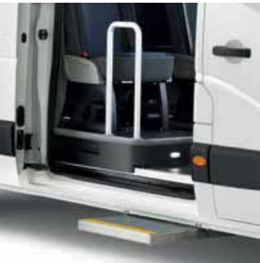
MARCHEPIED ÉLECTRIQUE RÉTRACTABLE pour permettre un accès facile au véhicule.
