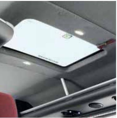
ISSUE DE SECOURS rétroéclairée sous pavillon.
