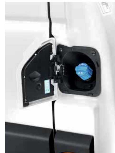
RÉSERVOIR ADBLUE® situé côté passager, avec une capacité de 22 l pour une autonomie jusqu'à 6300 km.
